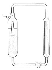
Schematische weergave van een commerciele Buss Loop Reactor (BLR).
